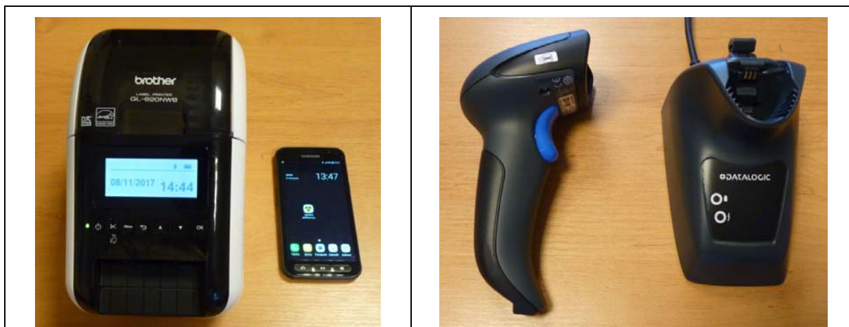
Obrázek 5: Mobilní telefon a tiskárna s baterií Obrázek 6: Čtečka QR-kódů s dokovací stanicí
