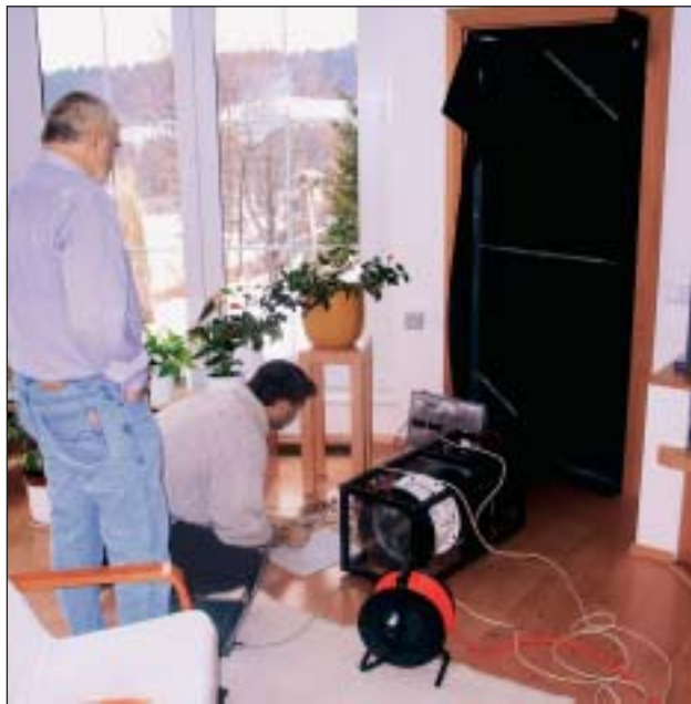
Aplikace BLOWER-DOOR v interiéru stavby
