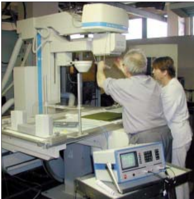
Zkouška rentgenů k typovému schválení
