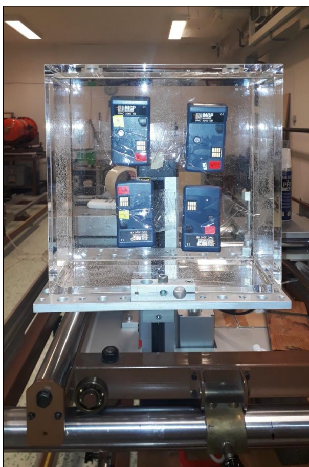
Obrázek 12: Elektronické osobní dozimetry ozařované na vodním fantomu („ICRU slab“) v kalibrační laboratoři SÚRO, v.v.i. pro účely experimentální studie v rámci projektu VI20192022156
