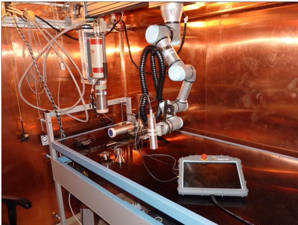
Obrázek 11: Funkční vzorek „detektoru ran“ vestavěný do stínicí komory celotělového počítače v SÚRO, v.v.i. v Praze
